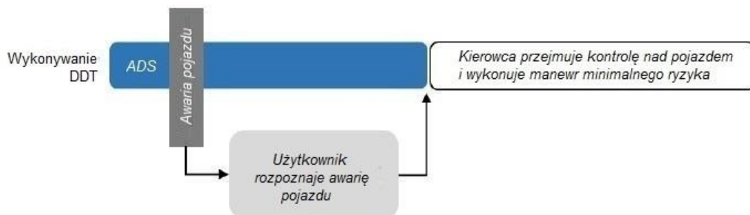
Rys. 2.21 Sekwencja ukazująca działanie ADS, awarię pojazdu i przejęcie kontroli nad pojazdem przez kierowcę
