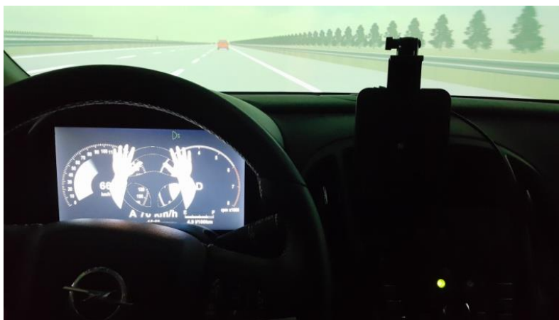
Rys. 3.6 Moduł wizualny stanowiska HMI przedstawiający konieczność przejścia kontroli – widok działania w symulatorze
