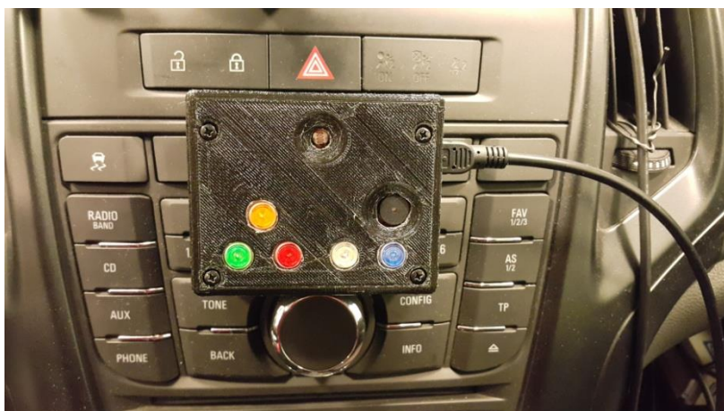
Rys. 3.9 Konsola użytkownika do zarządzania systemami ADS w symulatorze jazdy
