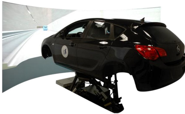
Rys. 3.2 Symulator samochodu osobowego AS1200-6
