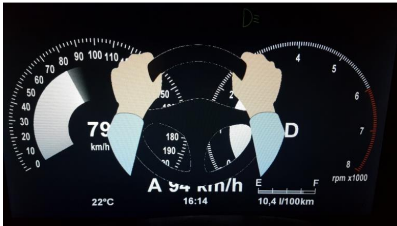
Rys. 3.5 Moduł wizualny stanowiska HMI przedstawiający konieczność przejścia kontroli
