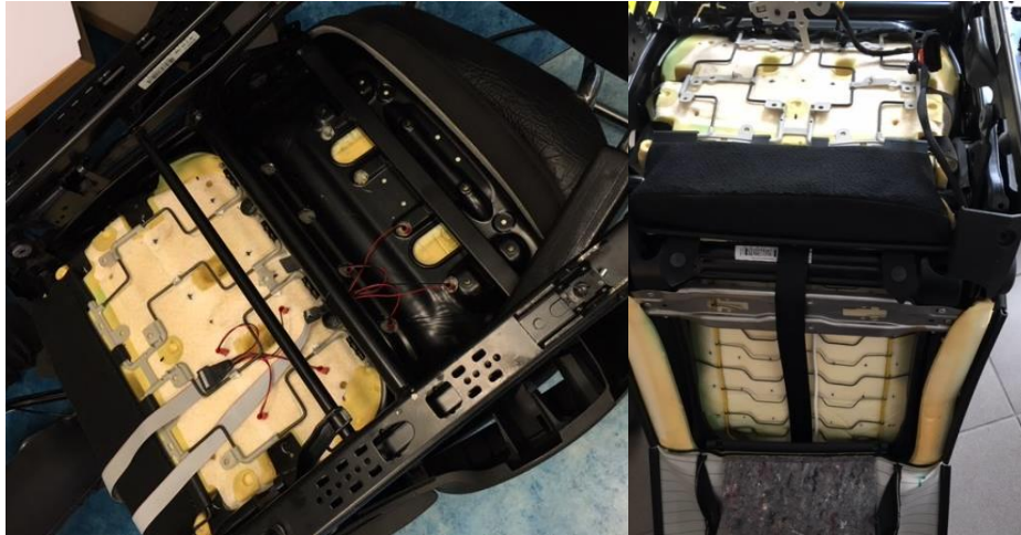
Rys. 3.8 Rozmieszczenie silników wibracyjnych w fotelu kierowcy – elemencie stanowiska haptycznego
